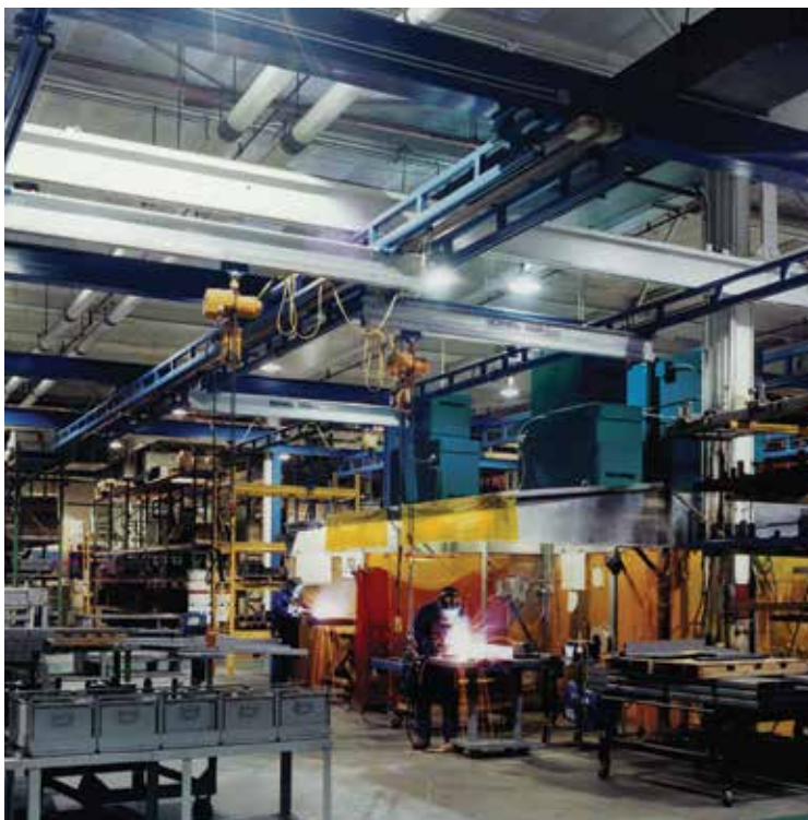
Grúas de puente para estación de trabajo de aluminio
