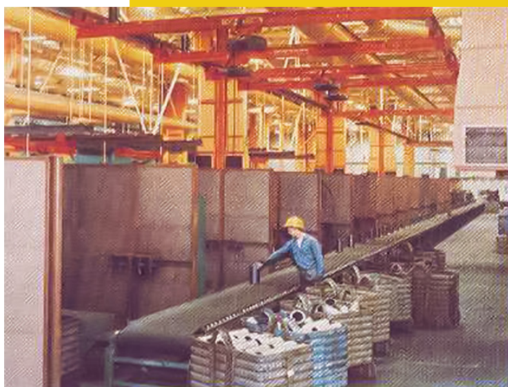
❸ КРАНЫ ДЛЯ ЛИНИЙ ОЧИСТКИ
