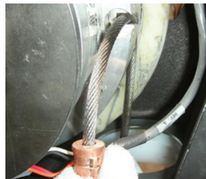
Schéma 7-8. Faites passer le câble de l'actionneur par l'ouverture sur sa partie inférieure et formez une boucle à insérer dans la rainure radiale.
