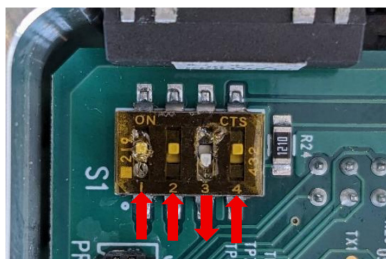
Schéma 3-7. Commutateurs DIP sur la carte mère de la poignée 1.
