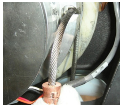
Abbildung 7-6. Führen Sie das Seil vom Aktor durch die untere Öffnung und bilden Sie eine Schlaufe, um es im Radienkanal zu befestigen.
