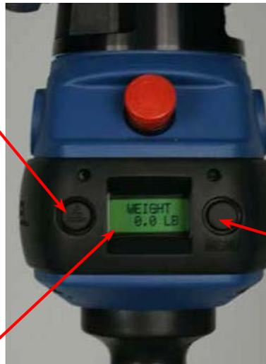
Drücken und halten Sie den Taster für ca. 3 Sekunden bis das System den Programmier-Modus aktiviert. Im Programmier- Modus tasten Sie sich zum gewünschten Menü durch. Drücken Sie den Taster erneut für den Sprung zum nächsten Menüpunkt. Haben Sie einen Menüpunkt versehentlich über- sprungen, können Sie sich erneut zu diesem in einer Schleife durchtasten.
