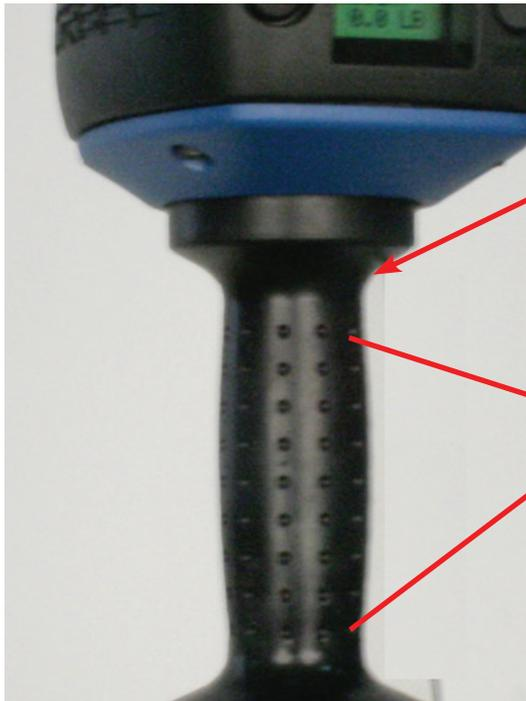
Assicurarsi di tenere le dita lontane dal sensore in modalità programma. L'interruzione del fotosensore farà uscire il dispositivo dalla modalità programmi, e sarà necessario ricominciare tutto dall'inizio.
