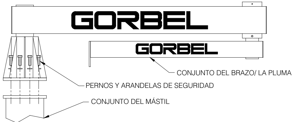
Diagrama 3A. Instalación del conjunto del brazo/de la pluma.
