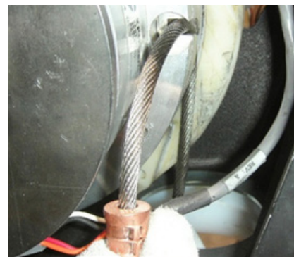
Diagrama 7-6. Pase la cuerda del actuador por la abertura de la parte inferior y forme un lazo para colocarla en el canal radial.
