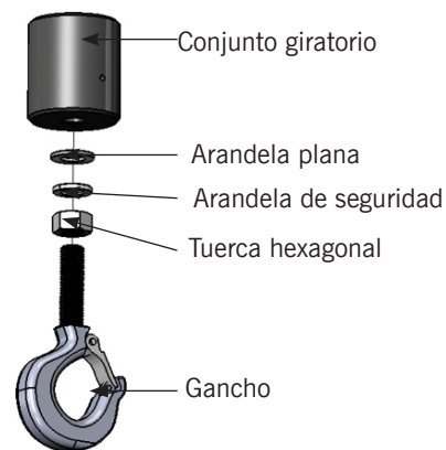
Diagrama 2-5C2. Instalación del gancho.
