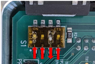
Diagrama 3-7. Interruptores DIP en la placa base del Mango 1 .
