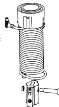
Diagrama 2-4A. Conjunto de cable en espiral estándar
