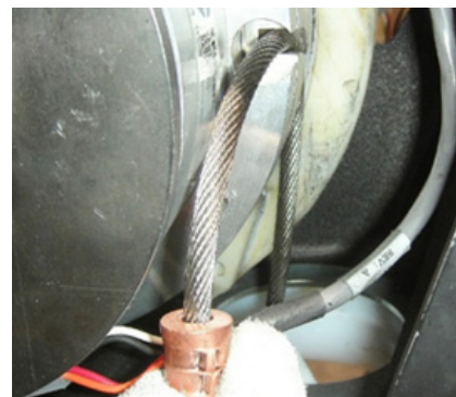
Diagrama 7-8. Pase la cuerda del actuador por la abertura de la parte inferior y forme un lazo para colocarla en el canal radial.
