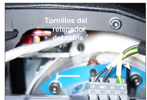
Diagrama S. Retire los dos tornillos de cabeza hueca M6 de las puertas del tambor.
