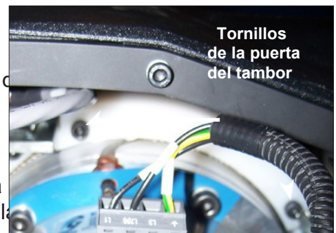
Diagrama S. Retire los dos tornillos de cabeza hueca M6 de las puertas del tambor.
