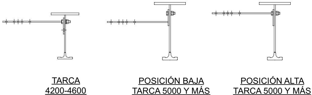
Diagrama 11A. Soporte de montaje de la barra conductora
