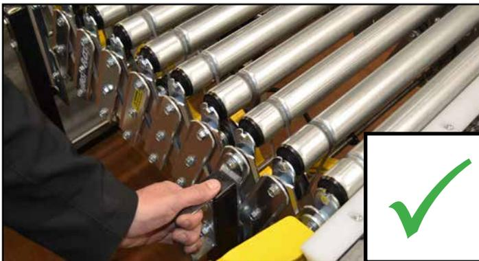
**Stellen Sie sicher, dass sich benachbarte Beine/Rollen an den Verbindungsstellen zwischen den flexiblen Abschnitten auf derselben Bodenfläche befinden, um eine ungleichmäßige Rollenhöhe zu vermeiden.**
