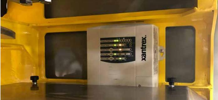
Schalten Sie den DC-Trennschalter auf dem Antriebspanel AUS.
