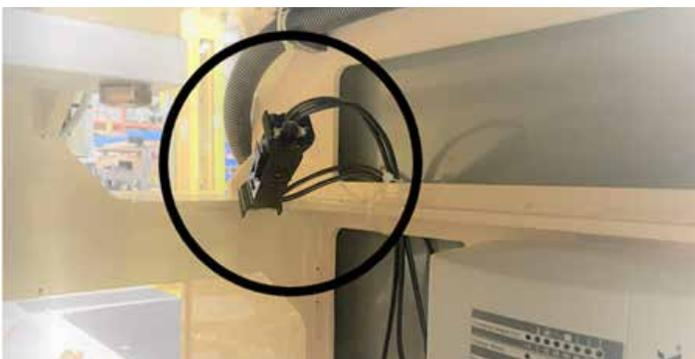
**Schritt 1** – Stellen Sie sicher, dass der DC-Trennschalter auf dem Antriebspanel AUS-geschaltet ist.
