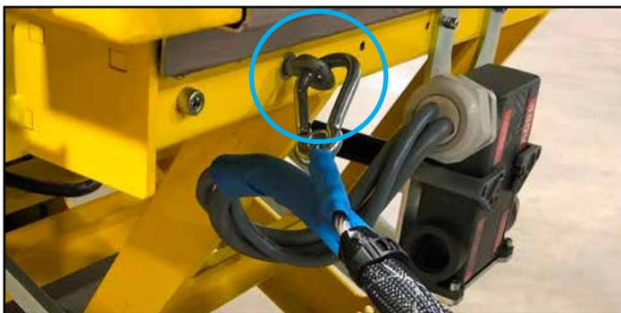
4. Heben und schieben Sie das Flex-Förderband in Haltebügel.
